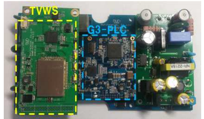
[그림 4] 유·무선 복합 브릿지 시제품
