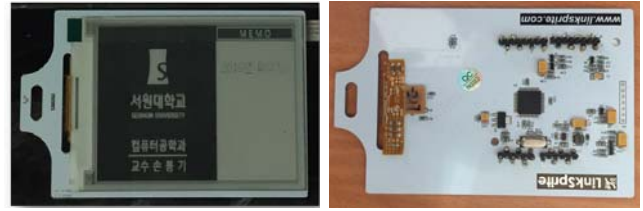
(a) E-paper 출력 결과 (b) E-paper 컨트롤러 (그림 7) E-paper 기반 도어사인 출력 결과
