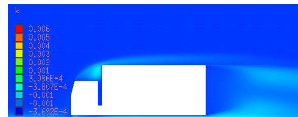
Fig. 16 기본형상의 난류 운동에너지 contour
