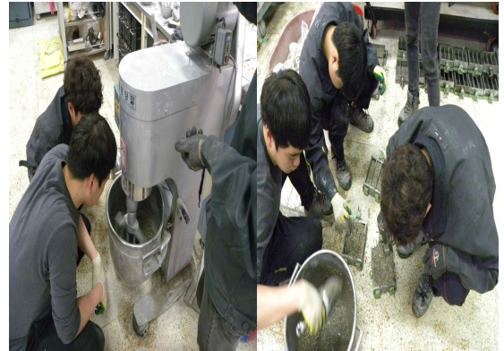
그림 2. 재료의 혼합 및 공시체의 제작과정
