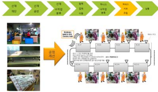
그림 1. 무선 하네스 컨베이어 구조도
