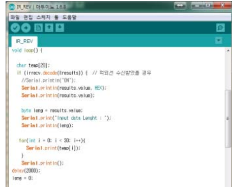
그림 3. 로봇 제어명령을 위한 아두이노 코딩
