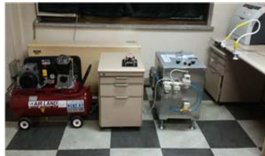
그림 13. 개발된 회전무게중심 검출을 위한 공압제어 및 영상검출 시스템 구성
