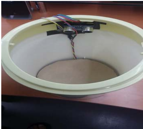
그림 5. WiT 모델 초음파 센서 및 무게 센서
