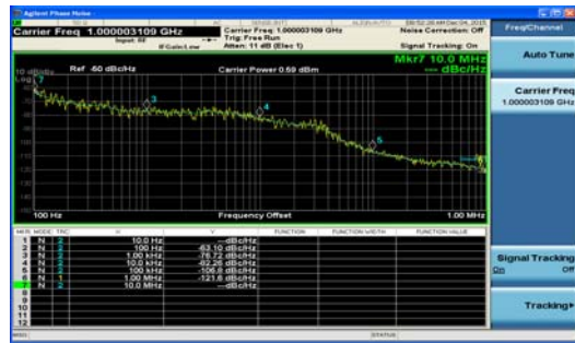
그림 4. Ka-band 위성방송 수신기(FEM) 위상잡음(Phase Noise)
