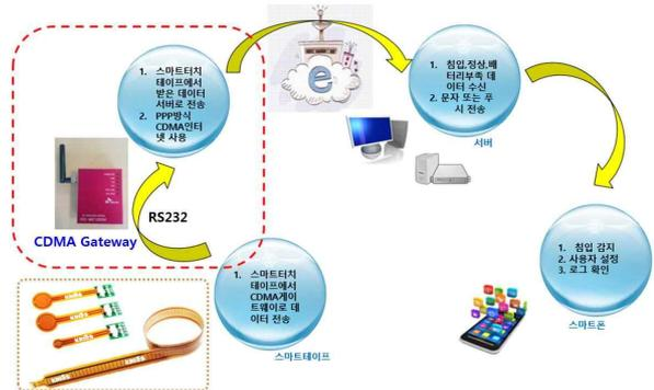
Fig. 4 압저항 센서를 활용한 스마트 안전시스템 개념도
