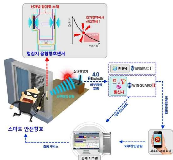
Fig. 5. 압저항 센서를 활용한 스마트 안전창호 시스템
