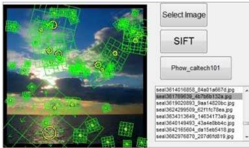
그림 2. SIFT 알고리즘을 이용한 이미지 분류
