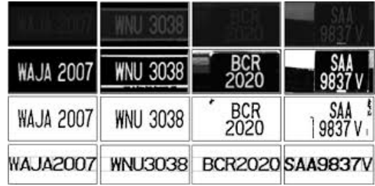
그림 1. 정규화, 문자분할, OCR 과정
