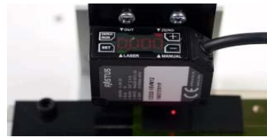
그림 3. 레이저 센서 (Fastus CD22-100-485m12)[5]
