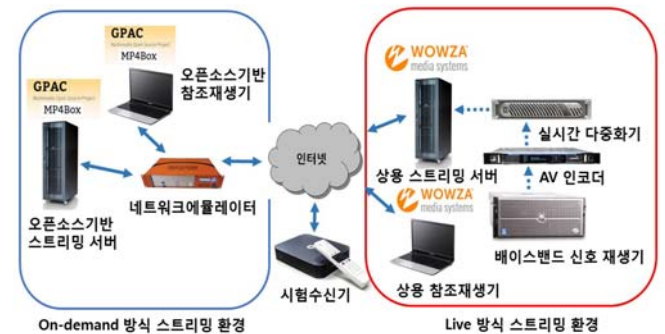
그림 1 스마트 TV 1.0 적응형 스트리밍 시험환경
