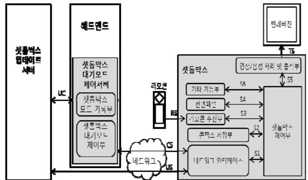
그림 1. 망연동수동대기모드를 지원하는 셋톱박스과 네트워크의 아키텍처
