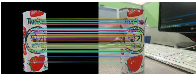
그림 2. 이전 프레임에서의 카메라 포즈로 객체를 렌더링 시켜서 원근 효과를 적용한 후, 현재 프레임에서의 카메라 영상과 특징점 매칭한다. 잘못 매칭 되는 특징점의 수가 현저히 적어진다.
