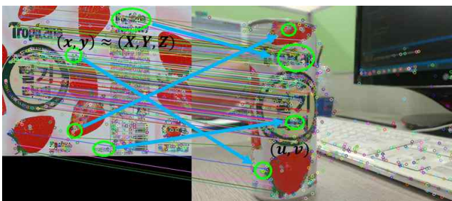
그림 1. 객체의 3차원 특징점과 카메라 영상의 2차원 특징점은 서로 매칭되고 카메라 포즈가 추정된다. 원근 효과가 고려되지 않은 3차원 특징점은 매칭 오류를 일으킨다.
