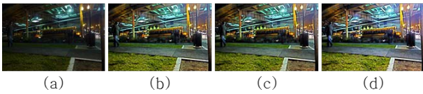
그림 1. 제안 기법의 각 과정별 결과: (a) 입력 영상, (b) 밝기 개선 결과, (c) 잡음 제거 결과 (d) 색상 복원 결과
