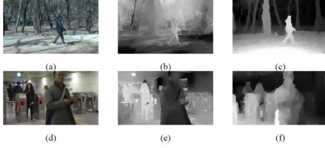
Fig. 2 초점흐림과 시차 맵 예시 (a) 'wp1' 158 프레임의 (b) 초점흐림 맵과 (c) 시차 맵 (d) 'mt1' 680 프레임과 그의 (e) 초점흐림 맵 (f), 시차맵
