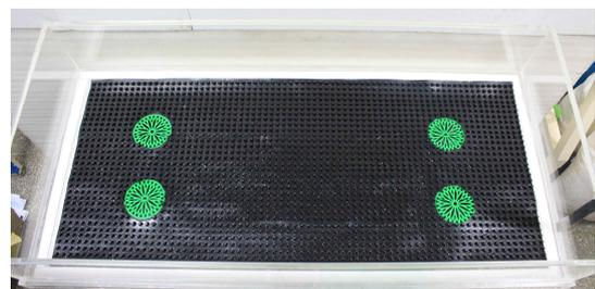
그림 3. 드레인보드, 유입공 커버, 상부 집수체 설치
