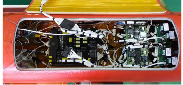
그림 2. Switching Box (좌)와 FCC (우)
