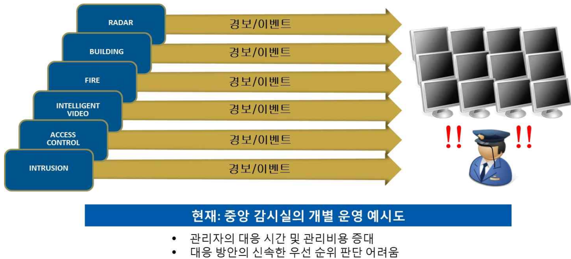
그림1 재난관련 장비의 분리된 시스템 운영 예시도(현 문제점)
