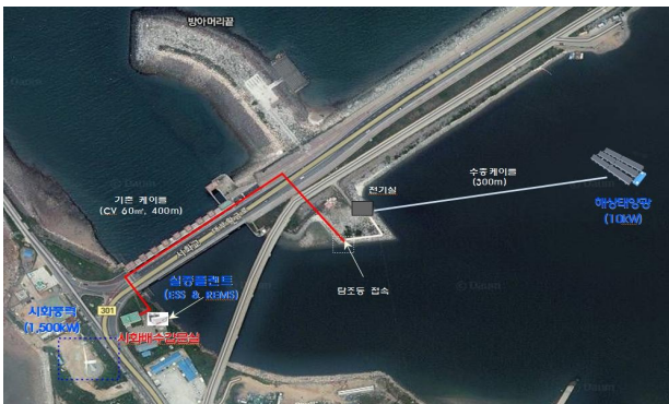
그림 1 신재생에너지관리시스템 실증플랜트 구성 Fig. 1 The configuration of the REMS demonstration plant
