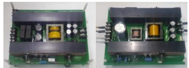
그림 6. 비절연형 Buck 컨버터 및 절연형 Flyback 컨버터 시제품
