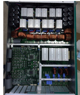
그림 2 파워 모듈 PCB 구성 Fig. 2 Power module PCB component
