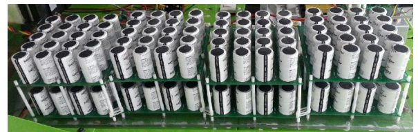
그림 2 수퍼커패시터 뱅크 (400V, 2.25F) Fig. 2 Supercapacitor Bank (400V, 2.25F)
