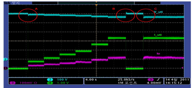
그림 5 ESS용 PCS 병렬운전(부하 분담 시험) 실험파형 V_{uti} [100V/div], I_{uti} [50A/div], I_o [50A/div]
