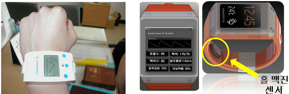
〈기 개발된 손목 착용형 맥진기 시제품과 스마트 워치에 적용한 모습〉
