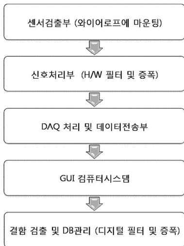
〈그림 1〉 와이어로프 결함진단 시스템 구성
