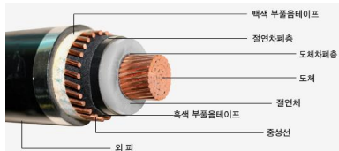
〈그림 1〉 CNCV 전력케이블의 구조
