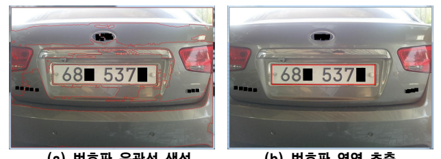
(a) 번호판 윤곽선 생성 (b) 번호판 영역 추출 〈그림 3〉 OpenCV-findContour를 이용한 번호판 추출
