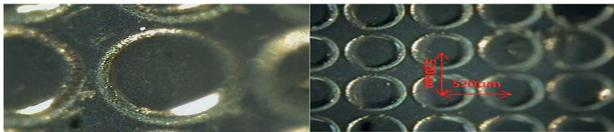
〈그림 3〉 공정이 완료된 후의 실제 습도센서의 사진
