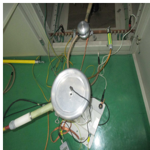
〈그림 5〉 PD 케이블 결선 및 전원선 제거 사진
