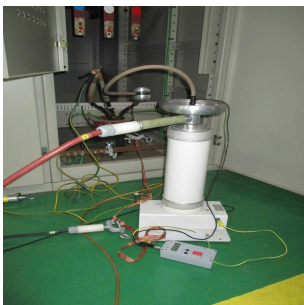
〈그림 5〉 PD 케이블 결선 및 전원선 제거 사진
