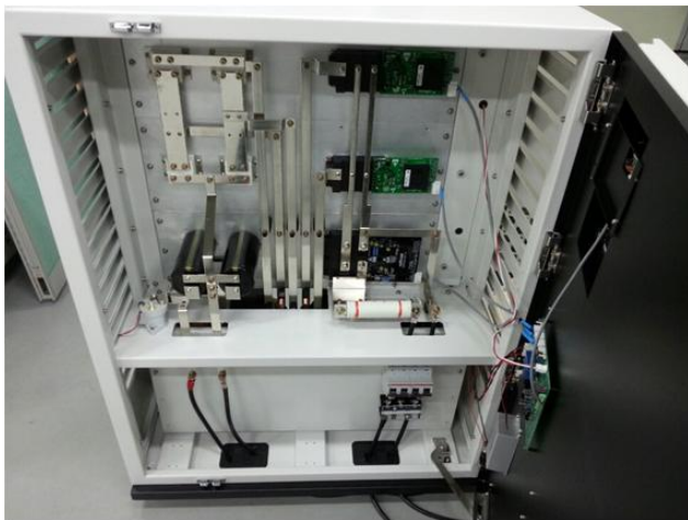
<그림 4> 고강압 DC-DC 컨버터 사진
