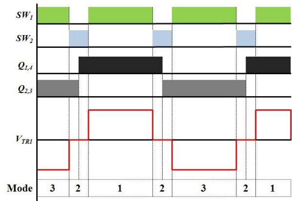
〈그림 2〉 모드별 스위칭 패턴 및 변압기 1차측 전압
