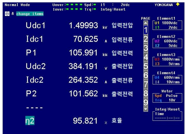
<그림 7> 고강압 DC-DC 컨버터 입, 출력 결과
