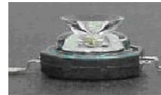
〈그림 1〉 1와트급 측면출광방식 LED 패키지 〈Fig. 1〉 1W side-emitter LED Package, (Lumileds, Co., Ltd)
