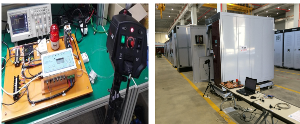
〈그림 5〉 아크플래시 검출 시스템 테스트베드(광스트로브)
