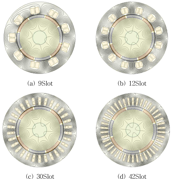
<그림 2.1> 전류 [0]일 때 Slot 수에 따른 Flux Line
