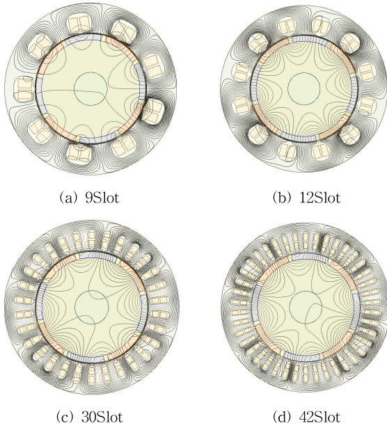
〈그림 2.2〉 회전자의 자석이 없을 때 Slot 수에 따른 Flux Line
