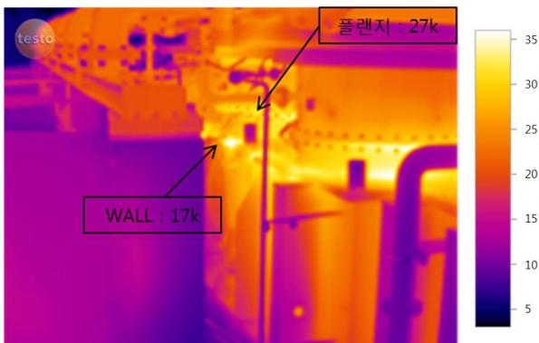
〈그림 6〉 열화상 카메라 측정 사진
