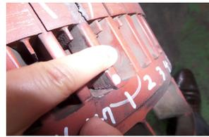
〈그림 9〉 Rotor Bar crack
