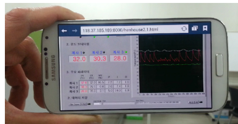
그림 5. 스마트폰을 이용한 계사 모니터링 화면
