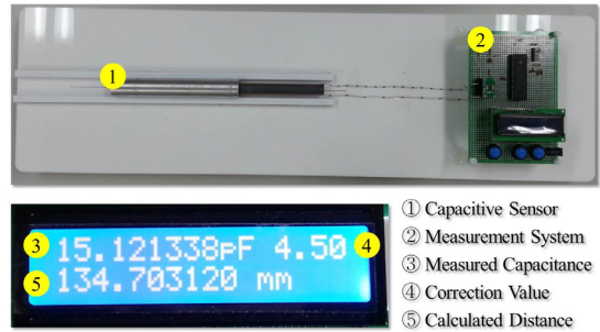
그림 5. 제안된 정전용량 센서와 변위 검출 시스템
