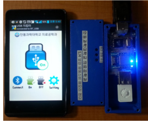
그림 9. 스마트폰 앱 및 Bluetooth 기반 스마트 USB 동작 화면
