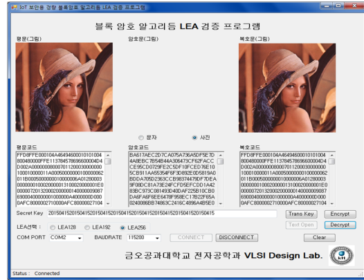
그림 4. LEA 코어의 FPGA 검증 결과 Fig. 4. FPGA verification result of LEA crypto-core
