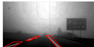
(c) 제안한 알고리즘을 사용한 인식 결과 그림 7. 안개 도로에서의 차선 인식 결과
