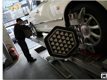
그림 3. 휠 얼라인먼트 장비로 편마모 측정 방법
