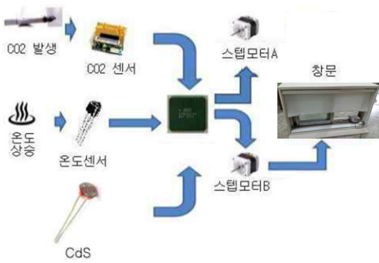
그림 1. 자동 실내 온도 제어시스템
