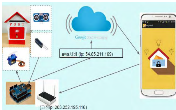
[그림 2] 개발한 IOT기반 메일박스시스템 실시간 알람구조
