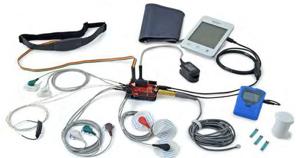
(그림 2) e-health보드에 센서를 연결한 사진.
