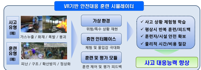
(그림 1) 안전대응 훈련 시스템의 개념
