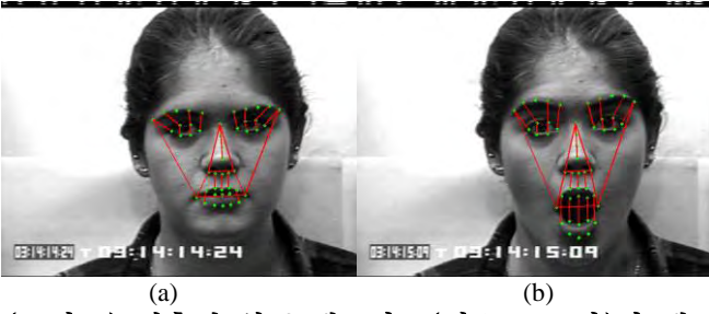
(그림 1) 검출된 얼굴 랜드마크(점으로 표시)와 랜드마크 간 정의된 거리(선으로 표시) (a)중립(neutral) 얼굴, (b)피크(peak) 표정얼굴
