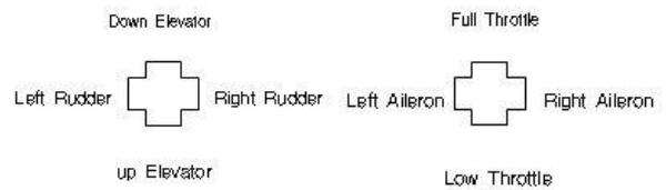
(그림 5) RC 송신기의 스틱 Left, Right 기능 분석
